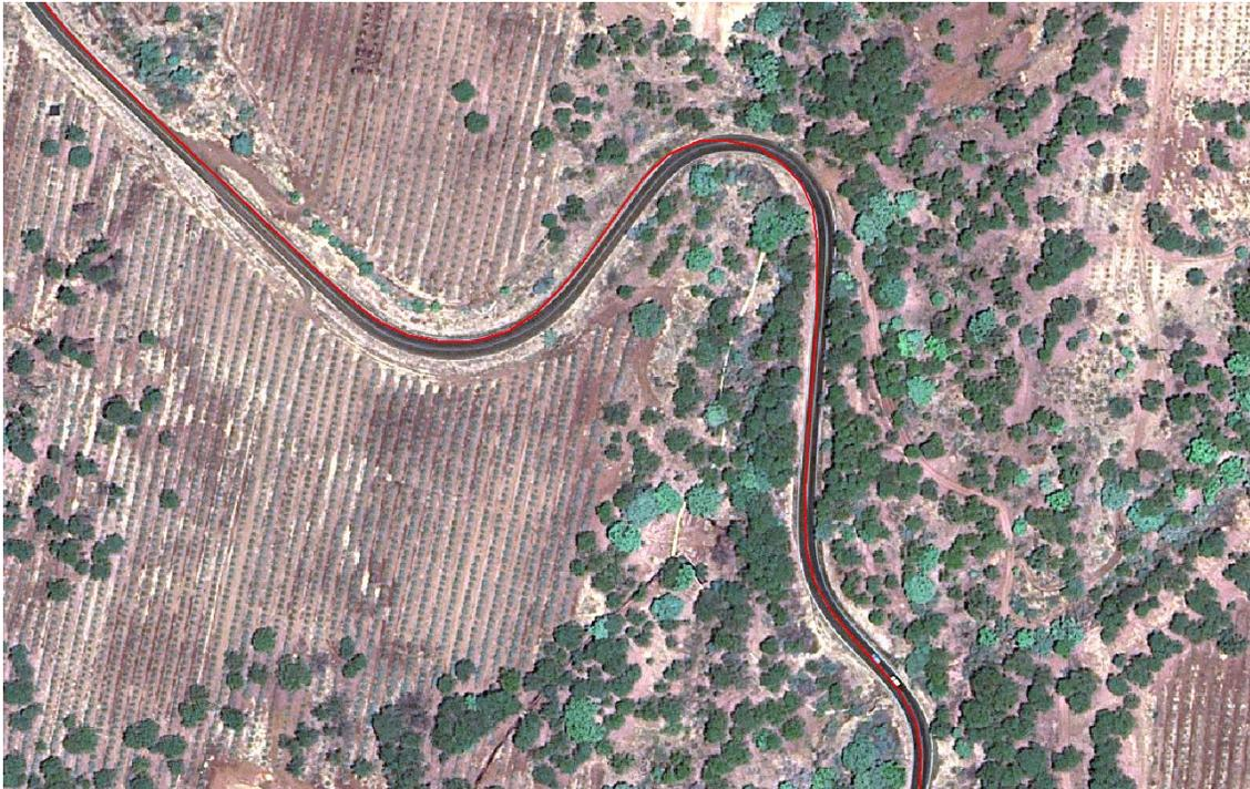
Figura 4. Ejemplo de imagen rectificadas para corregir las distorsiones presentes en la original. La línea roja corresponde al levantamiento del camino hecho con receptor GPS de alta precisión. Como se observa, el ajuste de la imagen es excelente, y el ligero desplazamiento que aun es posible observar es más que aceptable para la escala del inventario.
